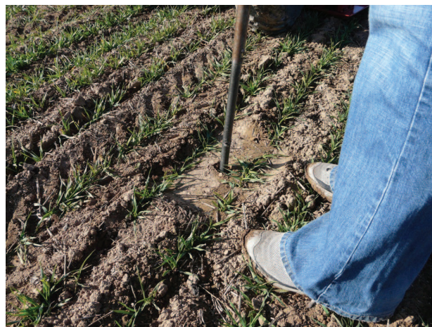
Imatge 5. Presa de mostres per a determinar el contingut de nitrats i humitat del sòl / Font: DARP 2008
